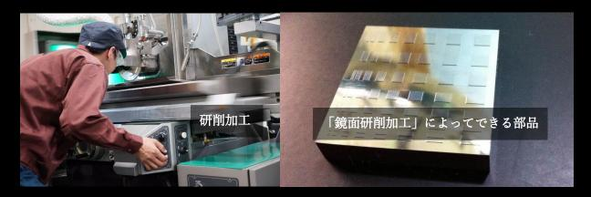
研削加工とは金属等の加工物に対して、研削盤を用いて機械加工を施すことで素材を削り取り、精密な寸法や形状を得る加工技術である。株式会社ミスズでは、独自の加工技術により、通常の研削加工に比べ表面精度を高め、加工物表面に鏡のような反射をもたらすことが出来る。一般的に磨き精度といわれる<u>面粗さ Ra=0.05 µ</u>以下になると、鏡のように曇りのない面ができる。この技術を「鏡面研削加工」と呼ぶ。
